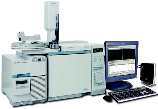
Şəkil 4. TENAX tüplərini analiz edən GC-FID cihazı (Mənbə: Agilent)
